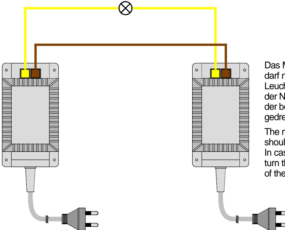
Das Modellbahnlämpchen darf nicht leuchten. Leuchtet es doch, muss der Netzstecker von einem der beiden Transformatoren gedreht werden.
