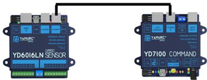
2. Spannungsversorgung der Zentrale zuschalten.
